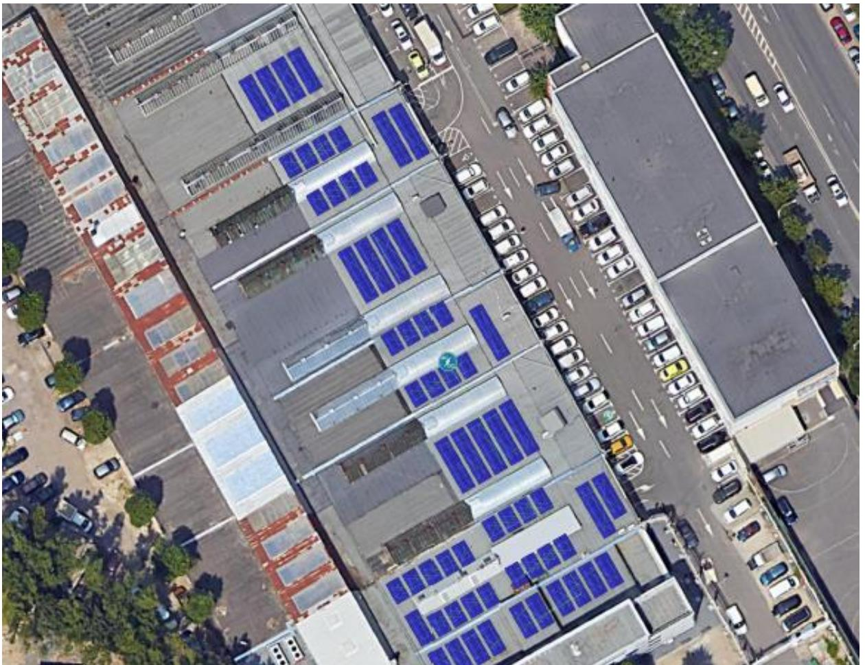
Beneficiarul isi propune instalarea unui sistem de panouri fotovoltaice pe o suprafata efectiv ocupata de panouri de aproximativ 740 mp, pe hala reprezentantei RAR Grivita. Constructorul va trebui sa puna in opera (instaleze) urmatoarele componente:
